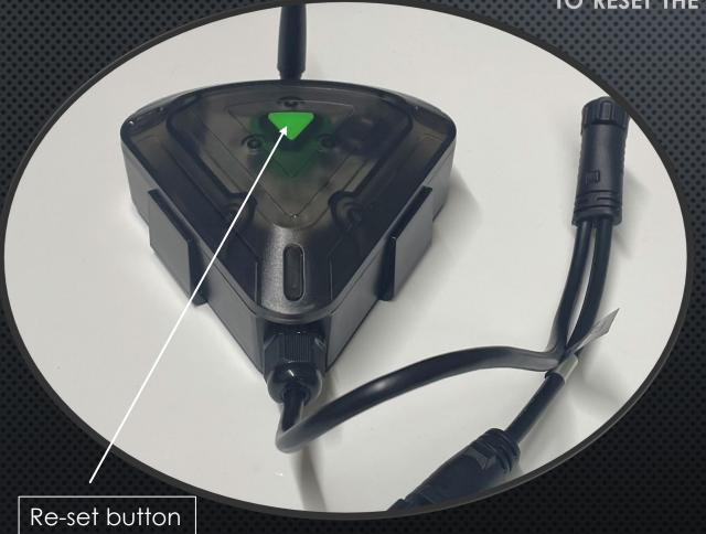
THE RESET BUTTON IS LOCATED ON FACE OF THE WEC+3.
